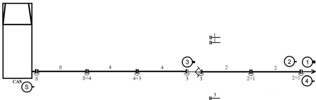
7) Provedení: Číslo 3 odpojí přechod B/C z prostředního výtokového hrdla rozdělovače a připojí jej na levé hrdlo. Dále číslo 3 na prostřední hrdlo rozdělovače připojí hadici útočného proudu B a na signalizaci čísla 1 pustí vodu a zůstává u rozdělovače. Číslo 4 odejde do útočného postavení, kde pomáhá číslům 1 a 2 při manipulaci s proudem. Druhý proud C družstvo 1+5 netvoří, ale počítá se s možností, že druhý (případně třetí) proud podle potřeby utvoří další družstvo 1+3 nebo 1+5.
